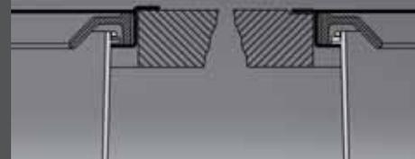
Einbau auf die Arbeitsplattenoberfläche aufgesetzt. On top of worktop.
