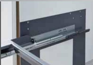
Die halben Schienen an der Einbauschablone montieren.
