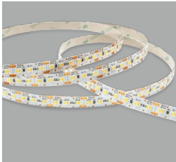
Strip Reel è una linea di circuiti stampati flessibili adatti per l'illuminazione decorativa e per l'integrazione con i profili Mec. Fornite in rotoli da 5 m sezionabili, sono disponibili a 12 o a 24 V, in tre densità ("G" 72 LED/m, "C" 108 LED/m, "E" 156 LED/m) e con temperatura di colore Naturale (4000K), Caldo (3000K), Freddo (6500K) o Emotion Dual Color che permette la variazione da 3000K a 4000K.
